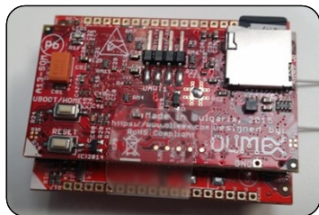
Kit 4G for IoT de Olimex Boitier pour tester les objets connectés en 4G
